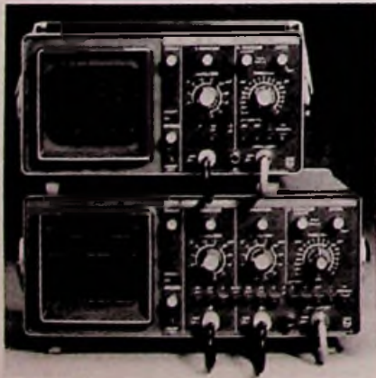
Links: Philips PM 3225/PM 3226: eenkanaals- resp. tweekanaaloscilloscoop met een grootste gevoeligheid van 2mV/cm.
